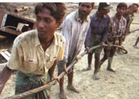
Szenenfoto aus dem Film „Eisenfresser“: Die Arbeiter verbinden abgetrennte Schiffsteile mit der Seilwinde, um sie an Land zu befördern.
